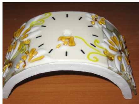
Рисунок 9. Фьюзинговая заготовка после программы моллирования
