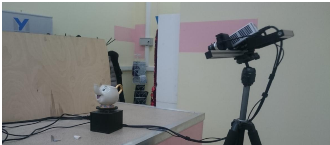
Рисунок 1. Сканирование прототипа на 3-d сканере
