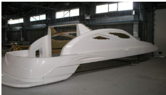
Рисунок 6. Корпус катера из стекловолокна
