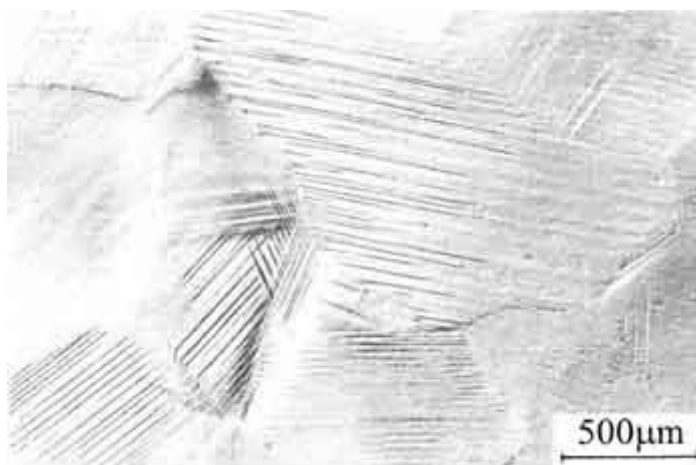
Рисунок 4. Характерная структура двойниковых системы
