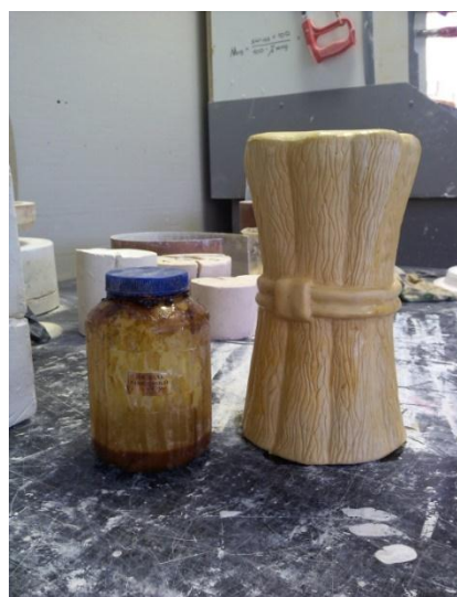
Рисунок 2. Рабочая модель, покрытая шеллаком и мыло-масляным раствором
