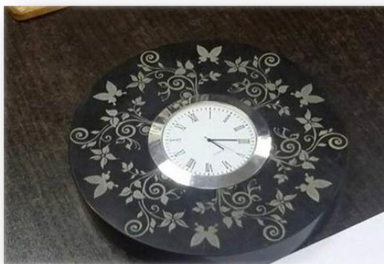
Рисунок 6. Пескоструйная обработка на корпусе часов
