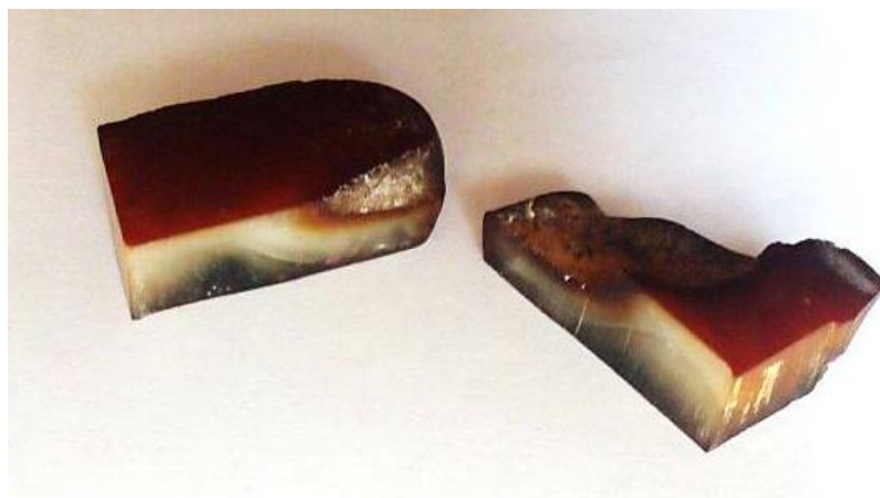
Рисунок 3. Янтарь в разрезе после термообработки при температуре 110°C в течение 3 часов
