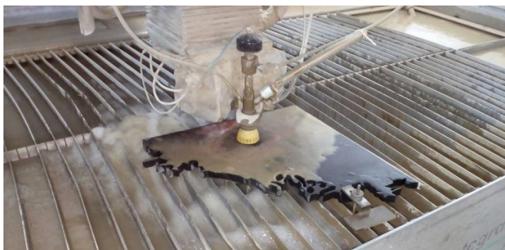
Рисунок 3. Процесс гидроабразивной резки плиты
