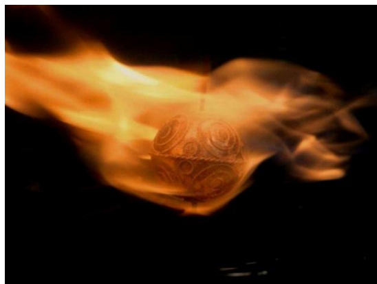
Рисунок 9. Процесс пайки филигранного изделия
