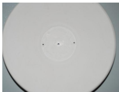
Рисунок 2. Сквозные отверстия в форме
