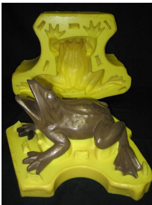
Рисунок 3. Пример отливки с введенным наполнителем
