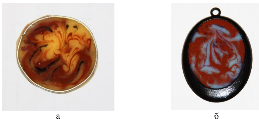
Рисунок 2. Результаты экспериментов по нанесению разных по цвету суспензий пятнами
