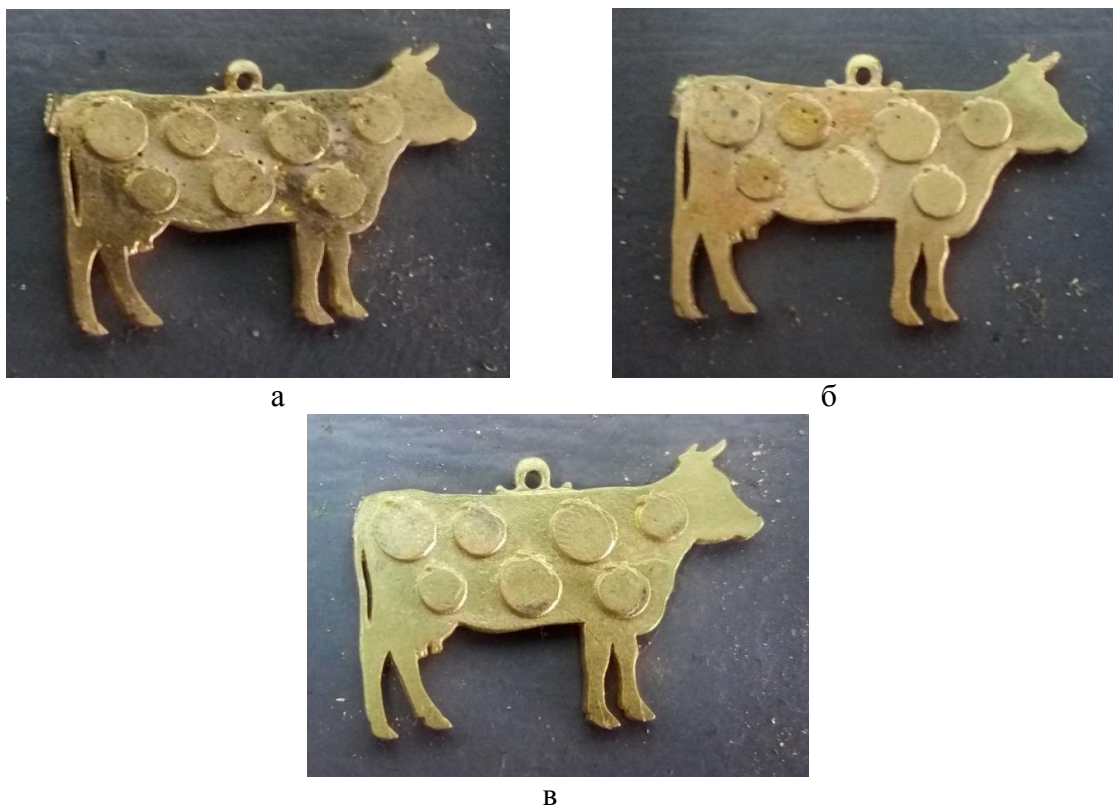
Рисунок 2. Отливки, изготовленные в формах с разными температурами: а – 500 °С; б – 550 °С; в – 640 °С
