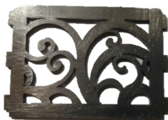
Рисунок 6. Деталь, сталь 3 холоднокатаная, 1 мм
