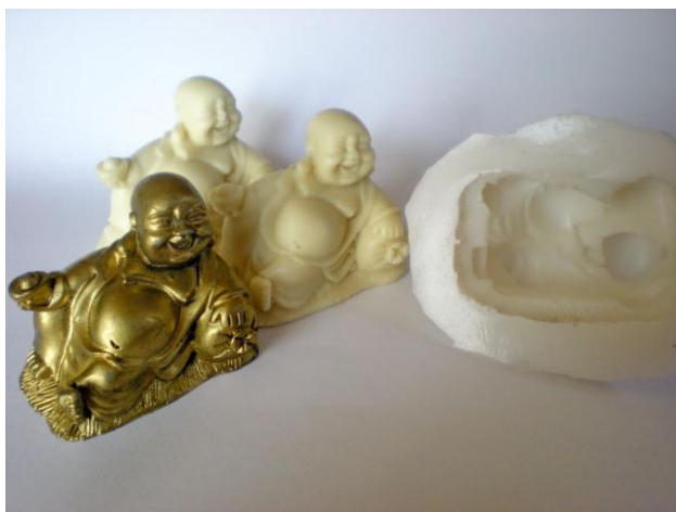
Рисунок 2. Пример отливки с декоративным покрытием
