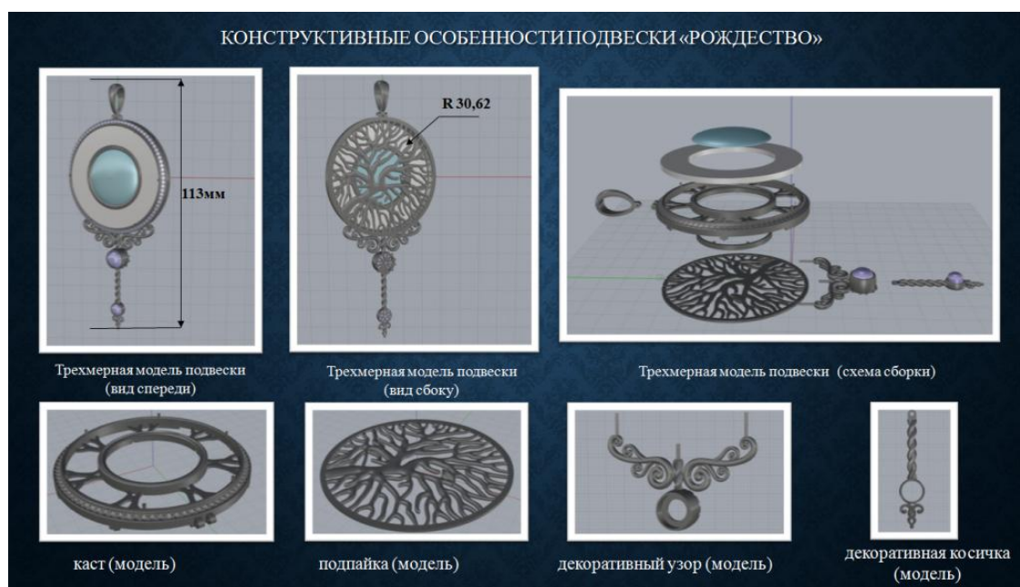
Рисунок 3. Конструктивные элементы изделия (ПО – Rhinoceros)
