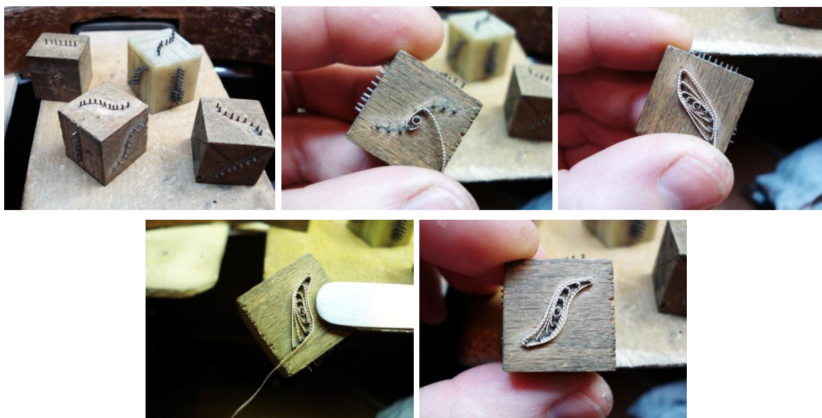
Рисунок 7. Процесс гибки филигранных элементов: а – при помощи пинцета-корцанга; б – гибка на ленивце филигранного элемента “листок”
