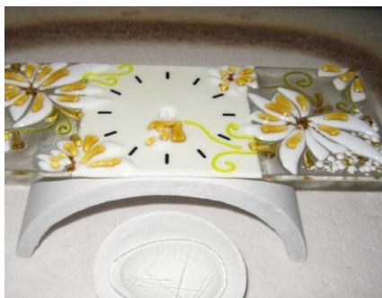
Рисунок 8. Фьюзинговая заготовка на форме из каолина с песком
