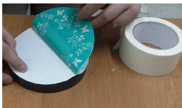
Рисунок 5. Процесс переноса изображения на пленке
