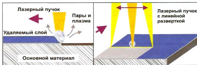
Рисунок 1. Принцип лазерной очистки
