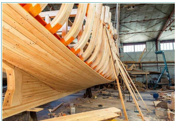
Рисунок 4. Каркас яхты изготавливаемой методом холодной формовки
