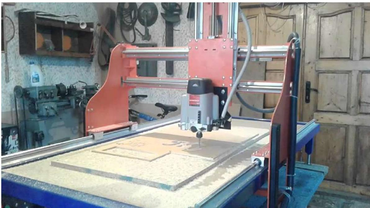
Рисунок 1 – Станок с ЧПУ
