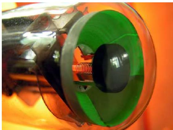
Рисунок 3– Индикаторная часть радиолампы 6E5C
