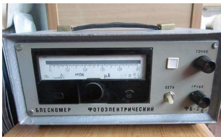
Рисунок 3 – Фотоэлектрический блескомер ФБ-2
