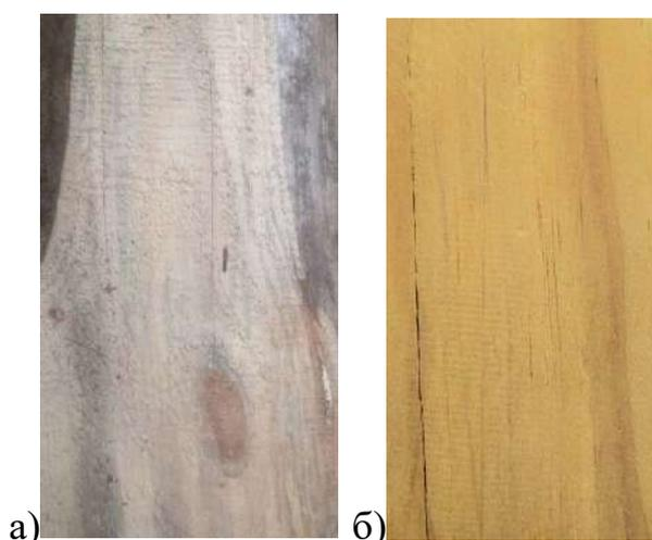
Рисунок 1 – Доска сосны: а) до термомодификации, б) после термомодификации
