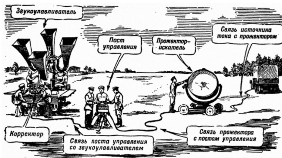
Рисунок 5 – Звукоулавливатель и прожектор-искатель
