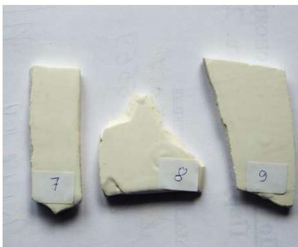
Рисунок 5 – образцы с нанесением глазури ГЛП 26-1 (15%) и силикатом циркония (10, 12, 15%)
