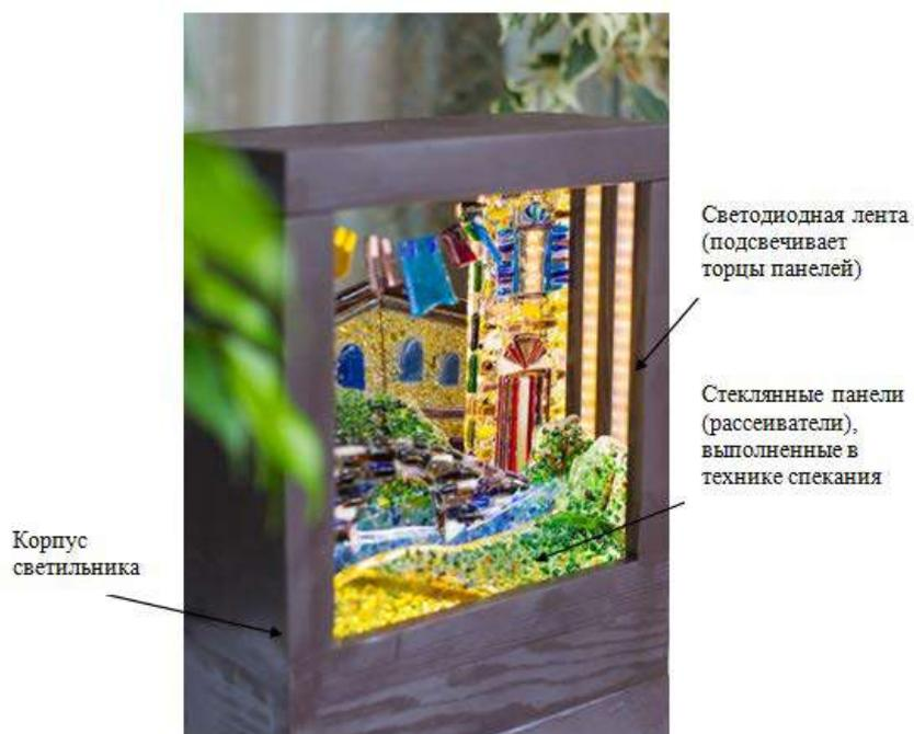
Рисунок 1 – Многослойный светильник, выполненный в технике спекания с торцевой подсветкой [1]
