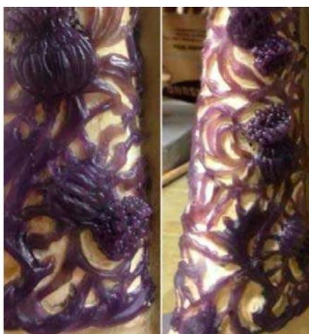
Рисунок 4 – Модель с технологическими перемычками
