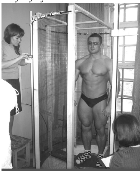
Рисунок 1 – Процесс получения трехмерных координат точек поверхности тела фигуры с РММ на HANDABTESTER (ИГТА)
