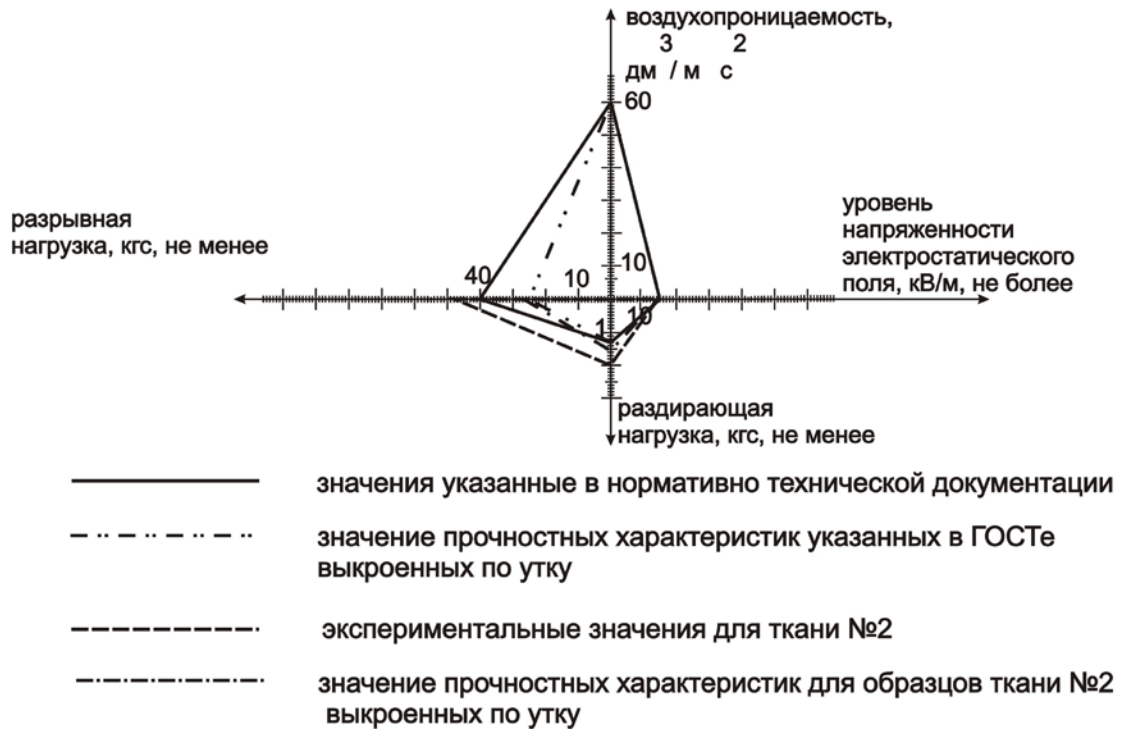
Рис. 2. Сравнение экспериментальных данных для ткани 2 со значениями нормативно технической документации
