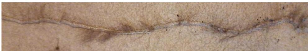
Рис. 5. Фотография искривленной строчки
