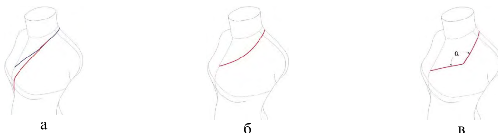
Рис.1. Конфигурация линии декольте в изделии: а – для воротника пиджачного типа; б – для воротника «отрезная шаль»; в – для воротника, в котором линия перегиба стойки и линия перегиба лацкана образуют ломаную линию
