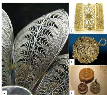
Рис. 3. Образцы филигранных изделий: а – выполнено вручную; б, в и г – изготовлено способами репродуцирования
