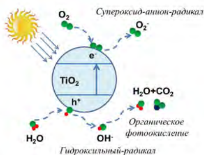
Рис. 1. Схема процесса фотокаталитических реакций
