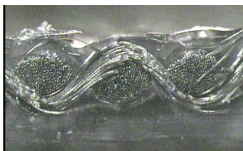
Рис. 2. Фотографии срезов ткани вдоль нитей: а – нитей основы, б – нитей утка Ткань 1: P_0/P_y = 16/15
