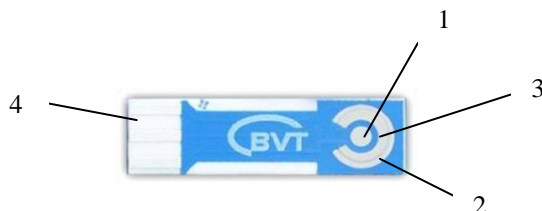
1 – Рабочий электрод, 2 – Вспомогательный электрод, 3 – Электрод сравнения, 4 – Контактное поле
