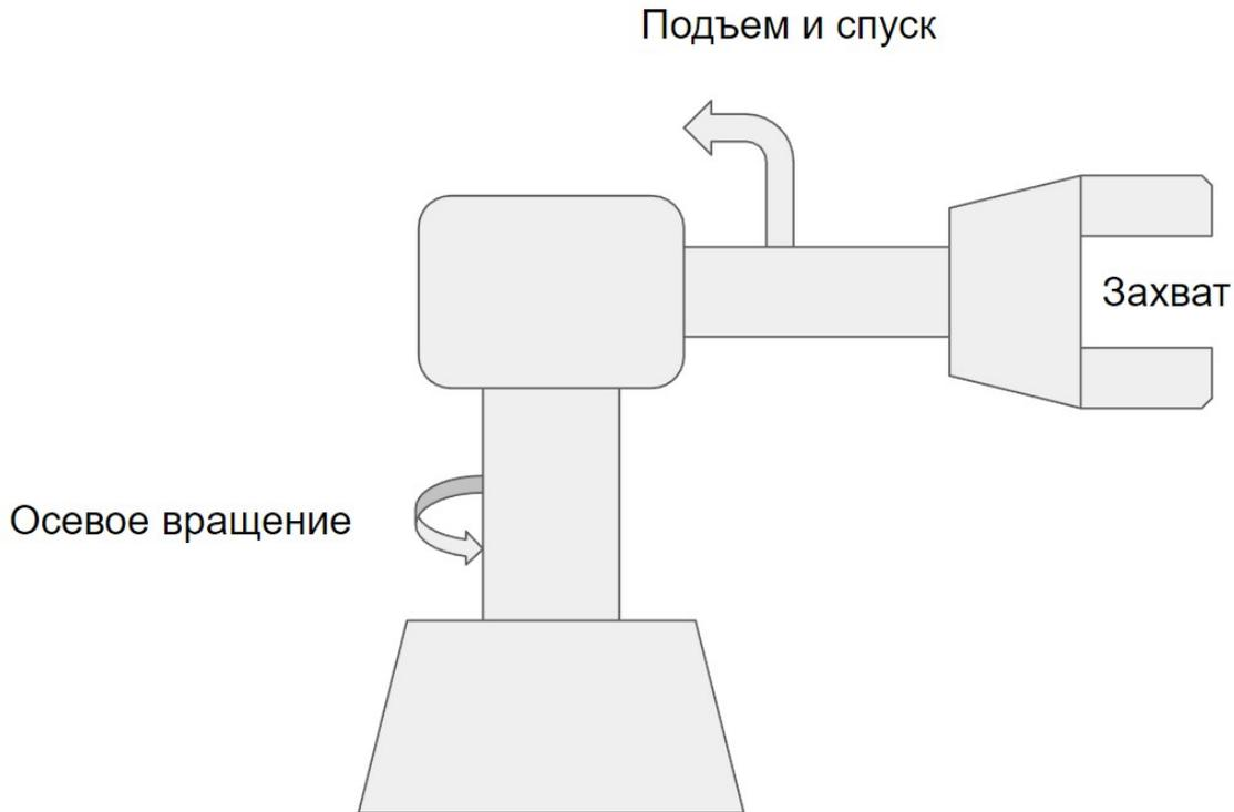
Рис. 4 – Кинематическая схема манипулятора
