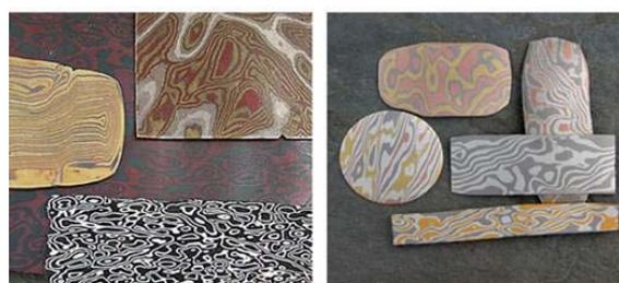
Рис. 5. Куски металла после процесса диффузии
