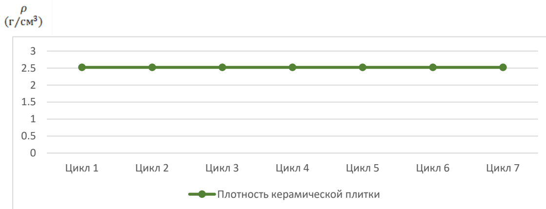
Рис. 7. График старения материала в экстремальном, температурно-влажностном режиме
