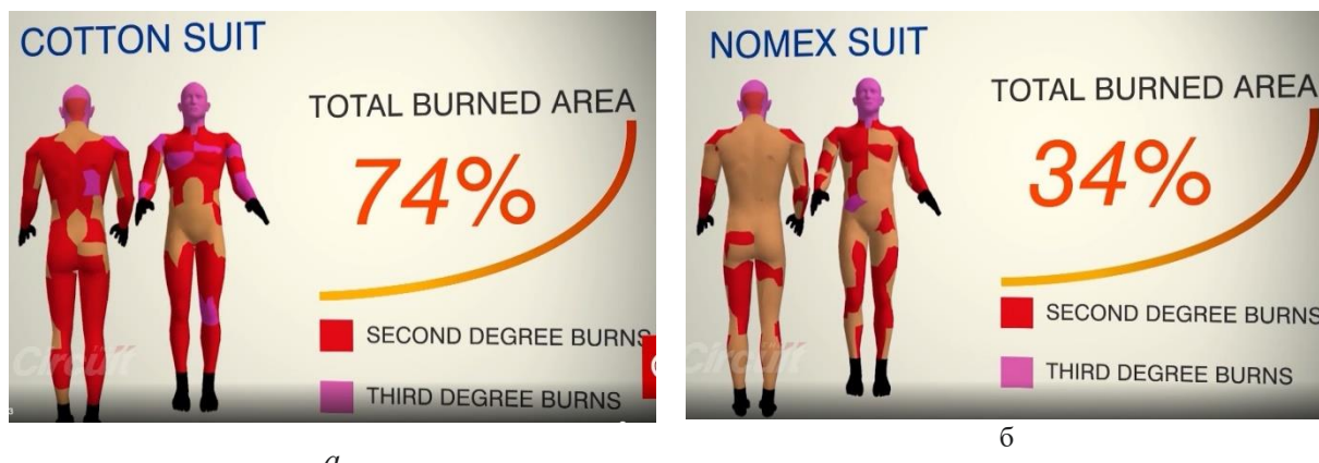
Рис. 2 – Результаты испытаний компании DuPont на огнестойкость: а – хлопкового костюма; б – костюма из материала Nomex
