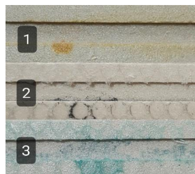
Рис. 4. Пористая поверхность керамической плитки после удаления пятен спиртовым раствором (1 – йод, 2 – черная тушь, 3 – бриллиантовая зелень)
