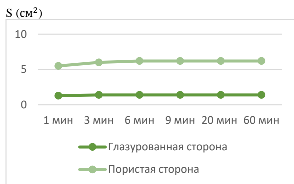
Рис. 3. График изменения размера капли бриллиантовой зелени на образцах
