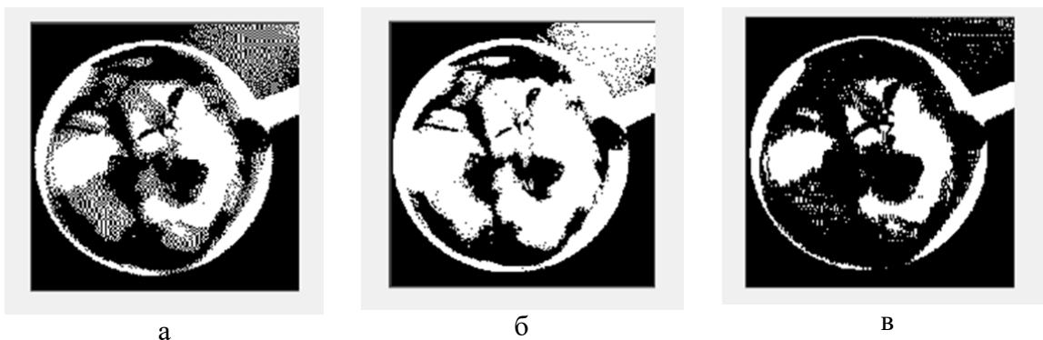
Рис. 1. Пример выполнения дилатации и эрозии с использованием функции strel : а – исходное бинарное изображение; б – дилатация; в - эрозия
