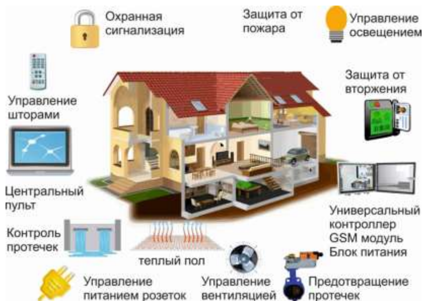
Рис.2. Устройство системы умного дома
