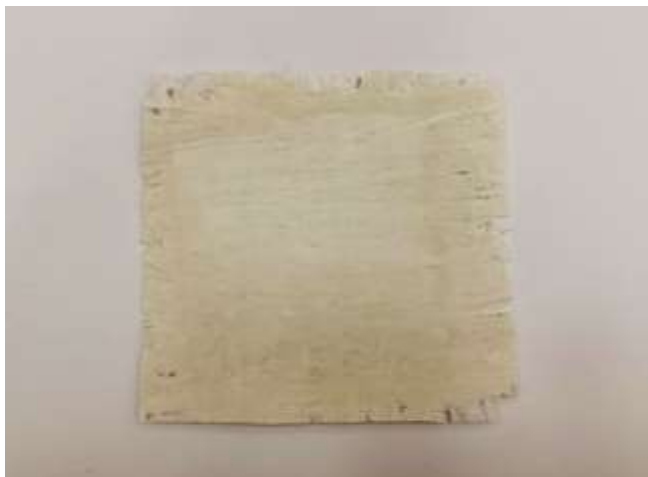
Рис. 8. Композит со смолой КФЖ
