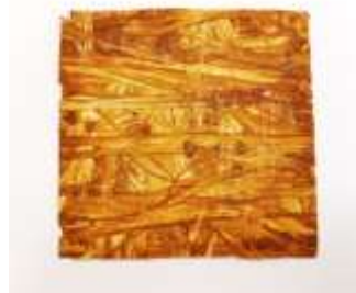
Рис.6. Композит с ФФС по технологии вымачивания (степень наполнения 85%)
