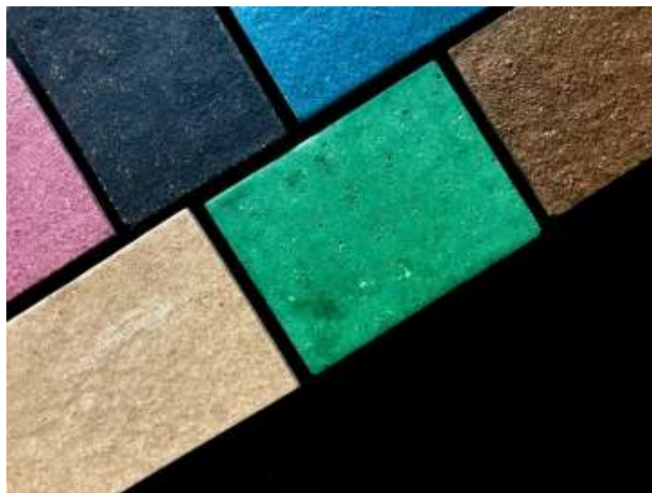
Рис. 4 Панели из картофельных очисток
