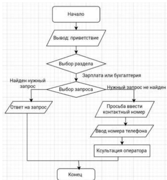
Рис.2. Блок-схема чат-бота поддержки клиентов в Telegram
