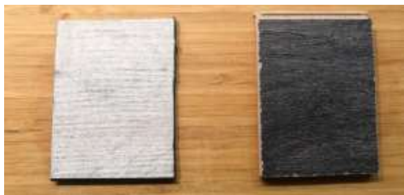
(Рис. 5.) Общий вид образцов плитки ПВХ и ламината до испытания.
