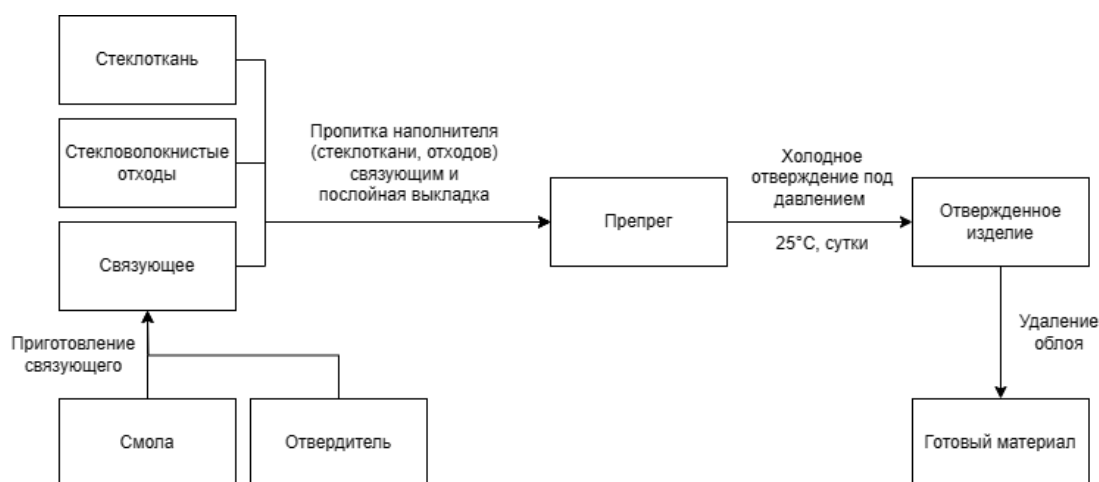
Рис. 9. Блок-схема технологии получения пресс-материалов с эпоксидной смолой
