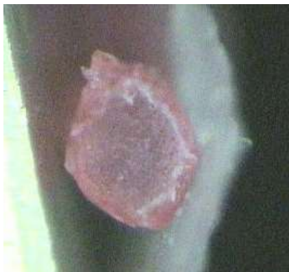
Рис. 1. Поперечное сечение струны Yonex BG 80
