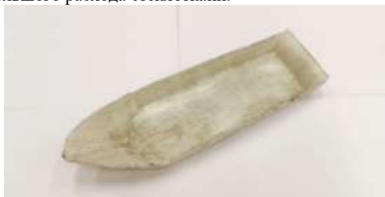
Рис.11 Лодочка стеклопластиковая (вид сверху)
