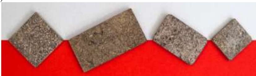
Рис. 3 Панели из картофельных очисток
